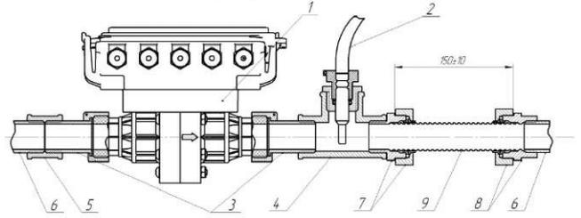
1. Теплосчетчик (водосчетчик)
