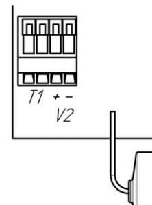
Рисунок 2. Расположение клемм счетчика воды САЯНЫ-Т РМД
