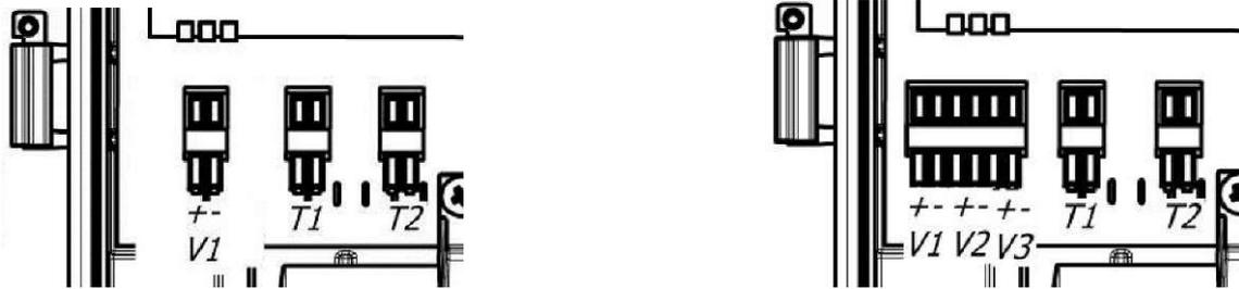
**Расположение клемм тепловычислителя без РМ**      **Расположение клемм тепловычислителя с РМ**
