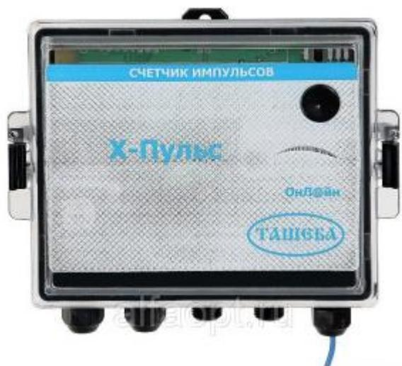
Счетчик импульсов многоканальный X-Пульс РМД предназначен для подсчета количества импульсов, поступающих на входы измерительных каналов от подключенных к ним измерительных приборов, имеющих импульсный выход, и пересчета количества импульсов в значение измеряемой величины путем умножения посчитанного количества импульсов на цену импульса канала.
